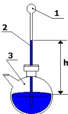
Итальянский физик Галилео Галилей первым сконструировал прибор, основанный на расширении тел от тепла, для исследования температуры. Типичная конструкция этого прибора представляет собой трубку, в которой жидкость поднимается и опускается при изменении температуры. Позднее в XVIII в. прибор был оснащен шкалой с цифрами.
