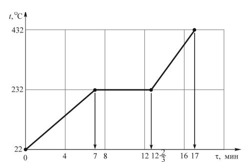
по физике — «Определение удельной теплоты плавления неизвестного вещества». Руслан включил печь, установив некоторую определенную мощность нагревания, поместил в капсулу кусочек исследуемого вещества, и ровно в  $10^{00}$  по московскому времени начал измерения. Когда Руслан отошел к учителю, скучающая Людмила тайком переключила тумблер установки мощности печи в другое положение (которое, естественно, не запомнила) и более его не меняла.
