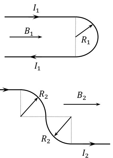
**Б)** Решите предыдущую задачу в случае, когда провод состоит из двух параллельных участков, которые соединены двумя проволочными четвертьками окружностей радиусом  $R_2 = 10$  см, как показано на рисунке. Ток в проводе  $I_2 = 30$  А, вектор индукции однородного магнитного поля  $B_2 = 1$  Тл направлен вдоль параллельных участков провода.
