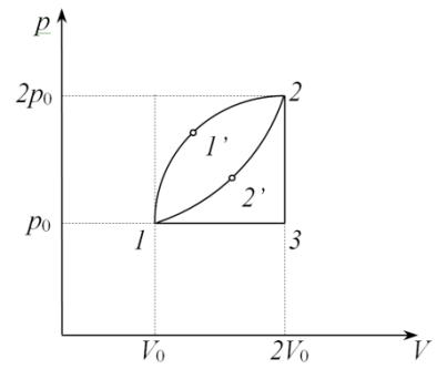
Б) Разделим данный цикл некоторой дугой 12'2 так, как показано на рисунке. КПД цикла 12'231 равен  $\eta_1$ . Определите КПД цикла 11'22'1.
