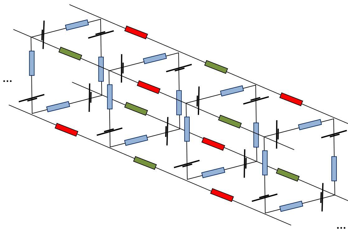
**Возможное решение.** Если рассмотреть два любых соседних контура (с источниками), которые соединены красными и зелёными нагрузками так, как показано на рисунке справа, то из симметрии следует, что по этим нагрузкам ток не течет. Следовательно, во всей цепочке
