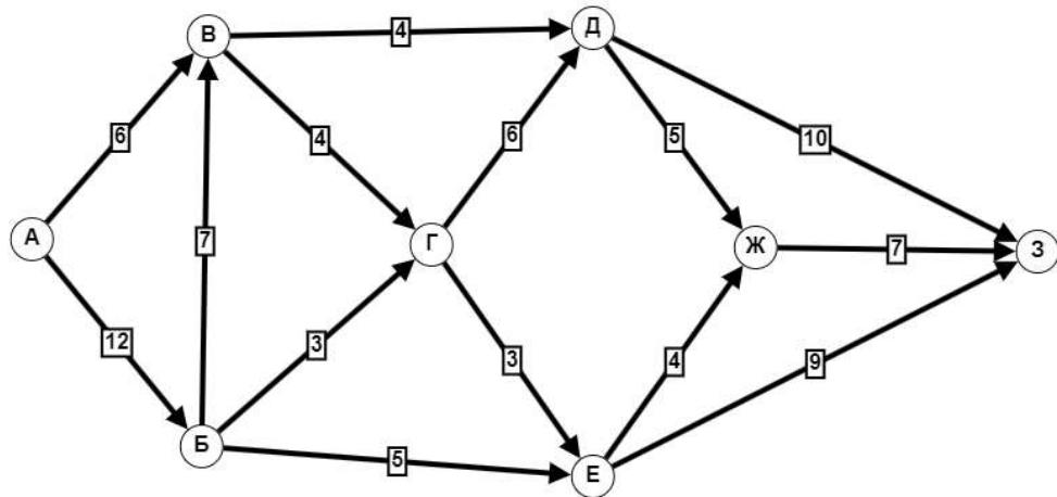
Буквами обозначены дома, направление движения воды указано стрелками. На каждой трубе цифрами показана максимальная пропускная способность трубы (кубометров в мин.). Считая, что источник воды находится в пункте А, а водосток находится в пункте З, укажите в ответе максимальное количество кубометров воды в минуту, которое можно запустить из источника, чтобы сеть выдержала такую нагрузку.
