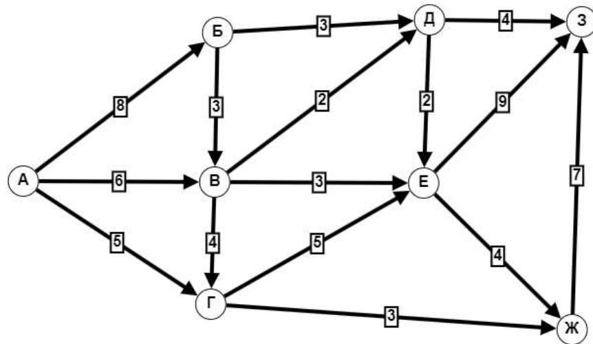
Буквами обозначены дома, направление движения воды указано стрелками. На каждой трубе цифрами показана максимальная пропускная способность трубы (кубометров в мин.). Считая, что источник воды находится в пункте А, а водосток находится в пункте 3, укажите в ответе максимальное количество кубометров воды в минуту, которое можно запустить из источника, чтобы сеть выдержала такую нагрузку.
